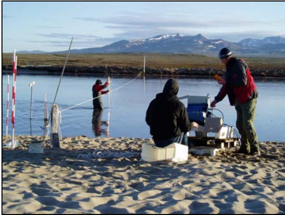
Figur 6. Instrumentopstilling ved tidevandskanalen. Bedloadmåling med kassemåler.
