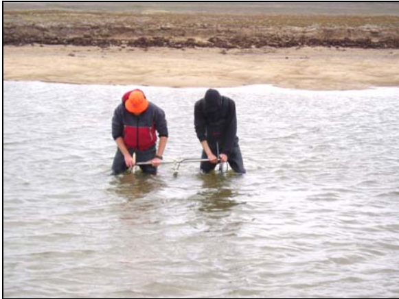
Figur 2. Marsh McBirney strømmåleren under opstilling omtrent midt i den dybe del af kanalen.
