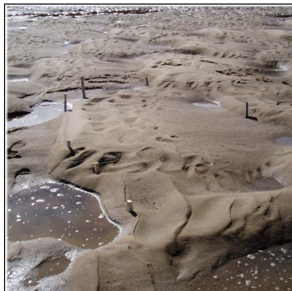
Figur 4. Bundform i tidevandskanalen, metode 1. Formen er afgrænset med pløkker for at kunne måle afstanden fra bundformen til pløkkerne efter næste tidevandsperiode og derved finde vandringshastigheden. Venstre side af billedet er retningen ind mod lagunen.
