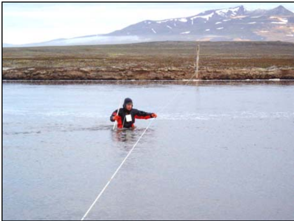
Figur 3. Strømmåling til brug ved midsection metode. Tidevandskanalen er på dette tidspunkt nær maksimal vandføring.
