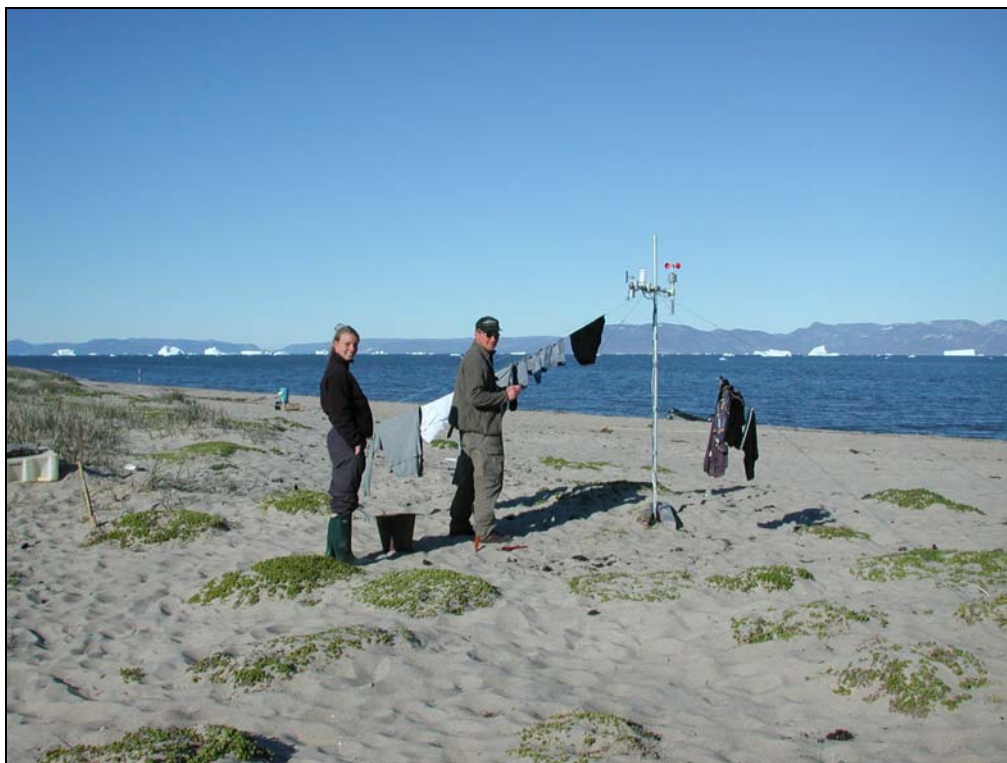
Figur 1. Klimamasten opstillet på Flakkerhuk, Disko. Sensorerne der er monteret i 2 meters højde måler, temperatur, vindretning og vindhastighed.
